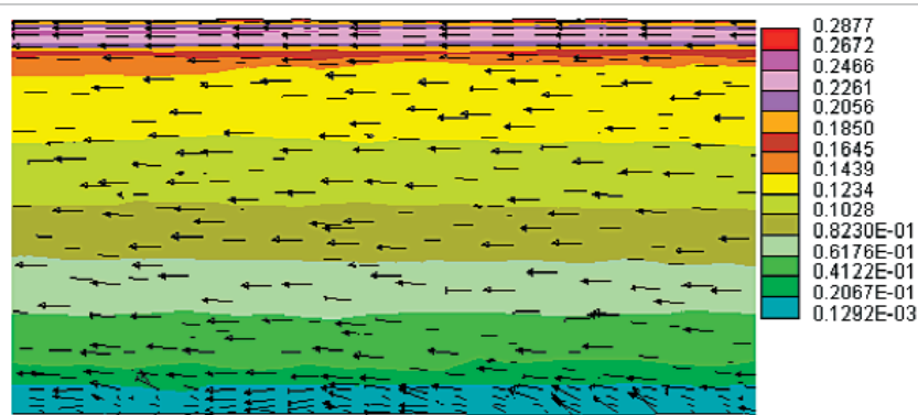
Рис. 5. Скорость несущей среды при наличии обструкции в продольном сечении трубопровода, м/с
